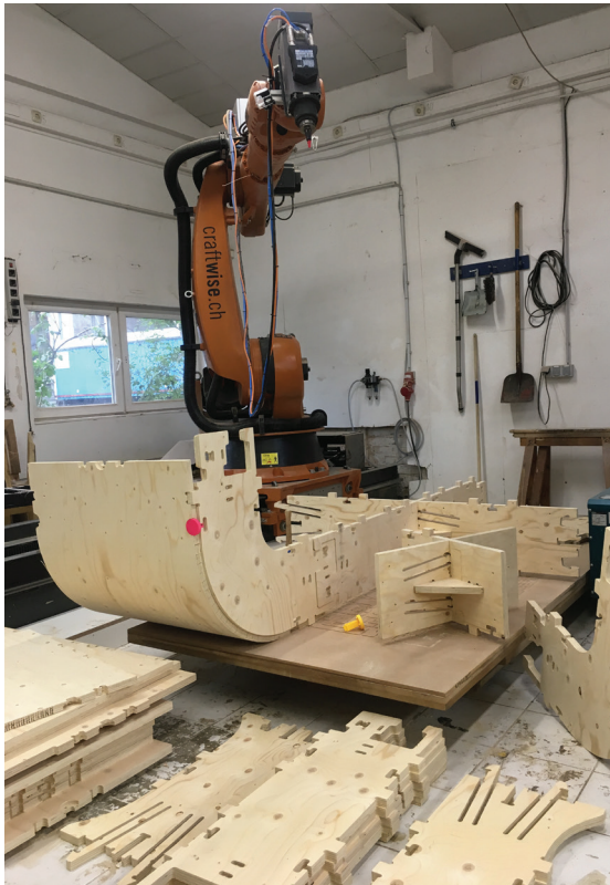
Digitale Fabrikation mit Hilfe eines 7-achsigen KUKA Industrieroboter
